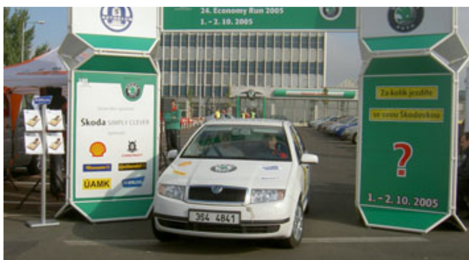
Před startem bylo každému vozidlu doplněno palivo a zapečetěna nádrž, stejně jako kapota motoru. Rovněž byl všem nainstalován sledovací systém Sherlog pro kontrolu dodržování trasy.
